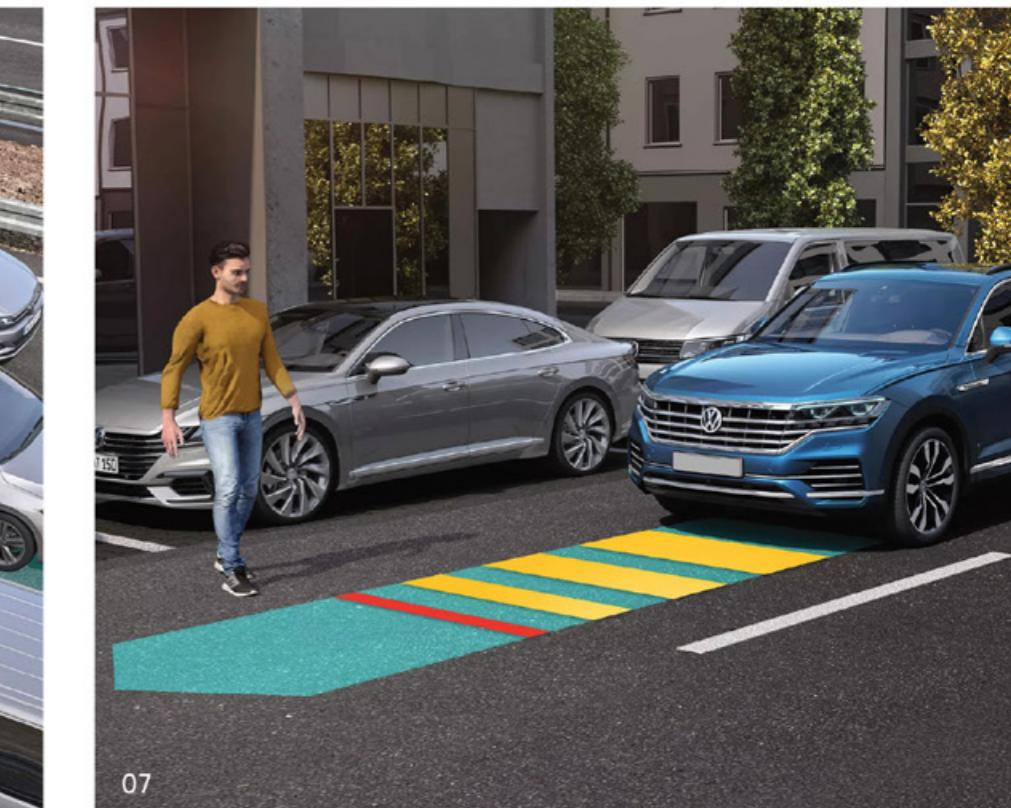
**07** City Emergency Braking tacili əyləc funksiyalı və piyada tanıma sistemi məsafəni öndən nəzarət etməyə kömək edən Front Assist sistemi toqquşma zamanı qəzanın nəticələrini minimuma endirməyə kömək edir, idealda isə qarşısını alır. Yolun hərəkət hissəsində olan piyadaları və avtomobilləri tanıyır, sürücünü bu obyektlər barədə dərhal xəbərdar edir. Reaksiya olmadıqda isə sistem tacili əyləci işə salır.
