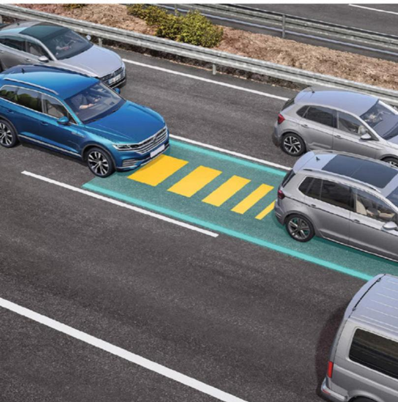
**06** Tıxaclarda belə daha çox rahatlıq: tıxac köməkçisi yol tıxaclarında rahat hərəkət etməyə imkan verir və bu cür hallarda tipik yol qazalarının qarşısını almağa kömək edir. Sistem avtomobili avtomatik olaraq qaz və əyləc idarəetmə sistemi olan yol boyunca idarə edə bilər.
